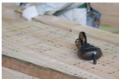
手板：伏図を元に継手や組み方などを反映させた大工さんの設計図
