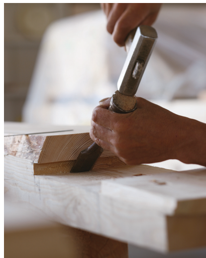
材は大工が手刻みで仕上げる
